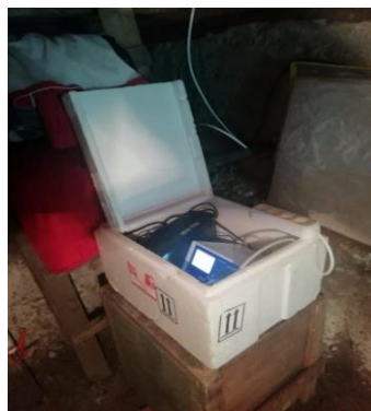
Рис. 20. Измерение объемной активности радона
