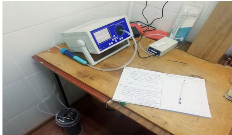
Рис. 18. Измерение объемной активности радона
