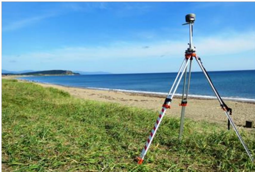
Рис.4 Базовая станция South Galaxy G1 устанавливалась на берегу и оснащалась в зависимости от внешних условий либо УКВ, либо GSM антенной. Ключевой участок Песчанское.
