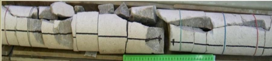
Субвертикальная не залеченная прямолинейная, местами слабоизвилистая макротрещина, протяженностью 95 см, в доломите светло-сером со слабым розоватым оттенком, мелкокристаллическом, плотном, неясно слоистом. Долбление-10, интервал глубин 2487,40-2488,35 м
