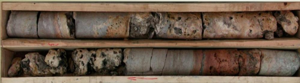
Керн продуктивной части разреза. Доломиты сильно выщелаченные, кавернозные, реликтово водорослевые, с сильным запахом углеводородов. С многочисленными крупными кавернами, преимущественно удлиненной, реже дырчатой и сложной формы размером 0,1-4см, 8см. Наиболее интенсивно они развиты в пластах и прослоях строматолитовых доломитов, залегающих в зоне аэрации довендского палеорельефа.
