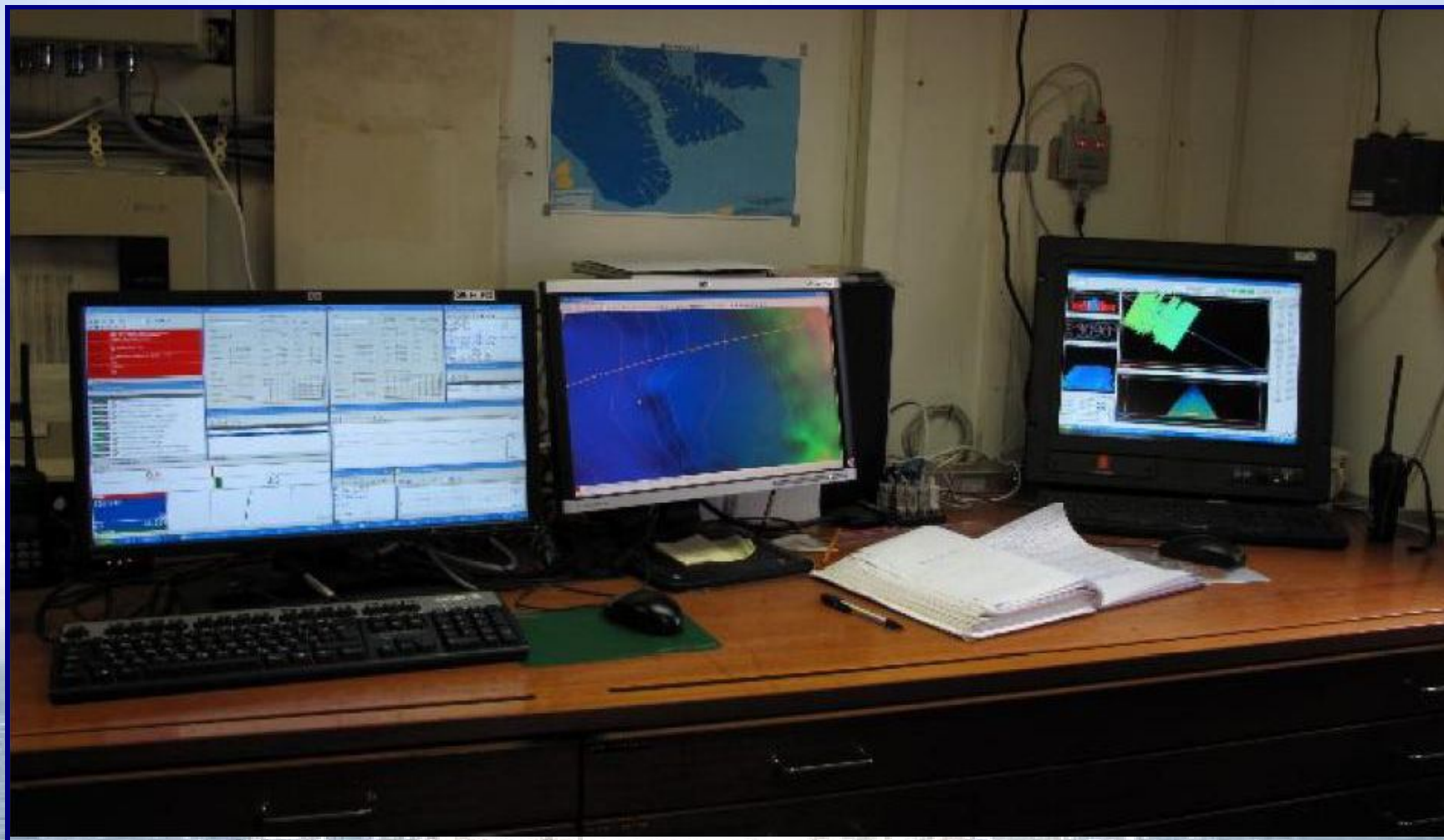
Навигационная система QINSy (слева) и on-line регистрация данных многолучевого эхолота EM-122 (справа)
