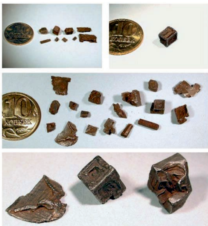
Рис. 3. Образцы россыпной платины из Угольного ручья, сформированные за счет разрушения рудно-интрузивных образований месторождения Норильск-I (диаметр монеты – 17 мм. Генералов М.Е. и др., 2005)
