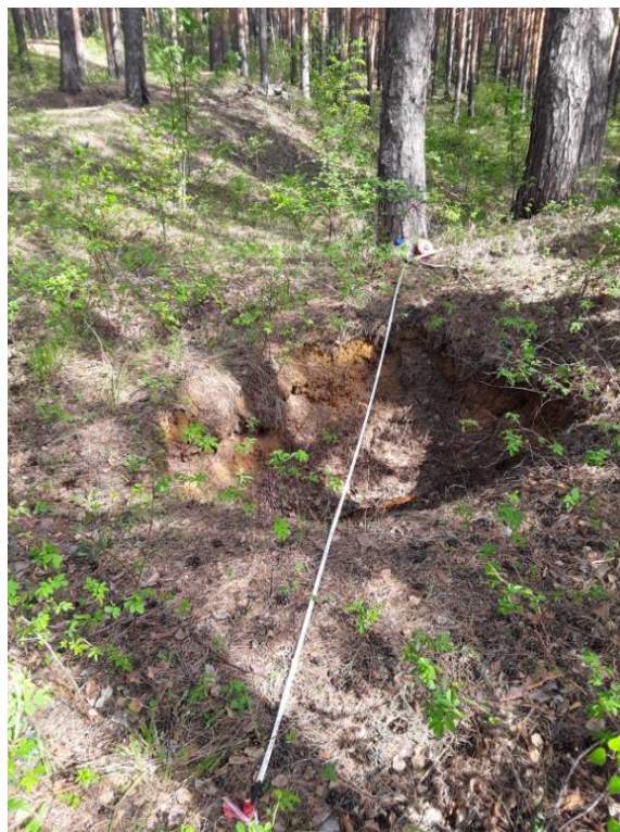
Рис. 3. Выполнение замеров для построения поперечного профиля воронки п.н. 66-1210-0522 (Участок Каменский 2)
