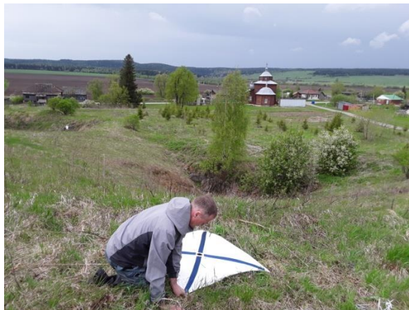
Рис. 5. Подготовка к проведению аэрофотосъемки с применением БПЛА (Красноуфимский участок)
